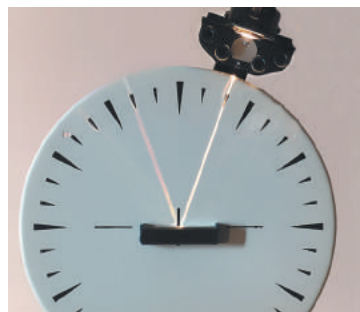
Рис. 25.3. Зі зміною кута падіння світла змінюється й кут його відбивання. Кут відбивання щоразу дорівнює куту падіння
