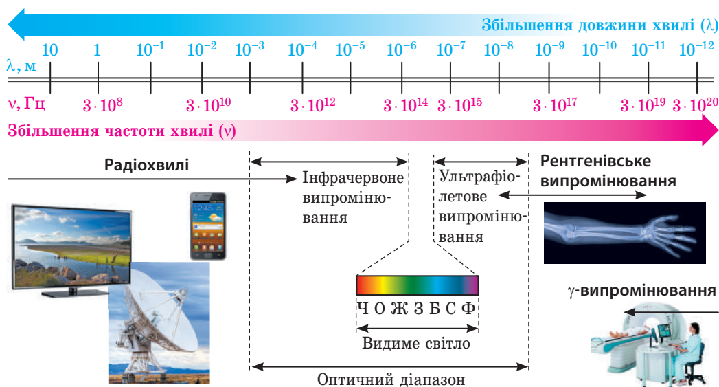
Рис. 35.1. Шкала (спектр) електромагнітних хвиль — безперервна послідовність частот і довжин електромагнітних хвиль, що існують у природі
