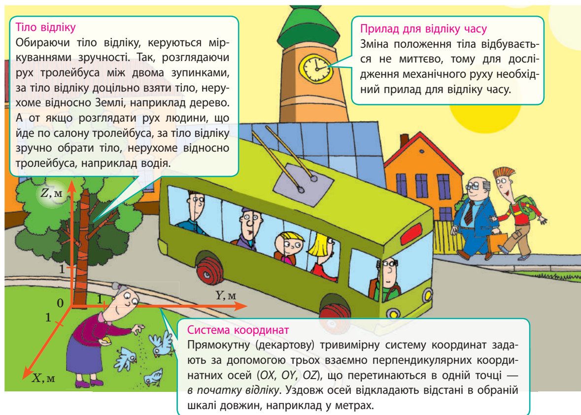
Рис. 4.2. Складники системи відліку: тіло відліку, система координат, прилад для відліку часу
