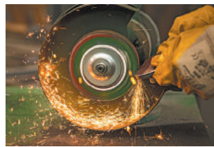
Рис. 8.2. Швидкості руху іскор феєрверка, бризок з-під коліс автомобіля, металевих ошурок напрямлені по дотичній до кола. Саме в цьому напрямку частинки продовжують свій рух після відриву
