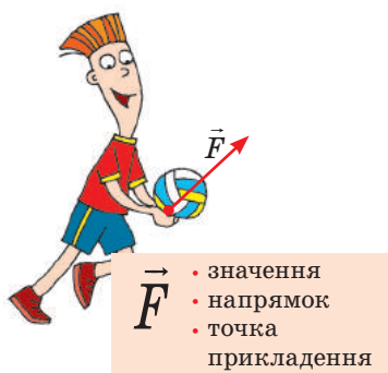
Рис. 10.1. Якщо ви, граючи у волейбол, ударите по м'ячу, то можете прискорити його рух, зупинити, змінити напрямок руху або закрутити — це залежить від напрямку, точки прикладення й сили удару
