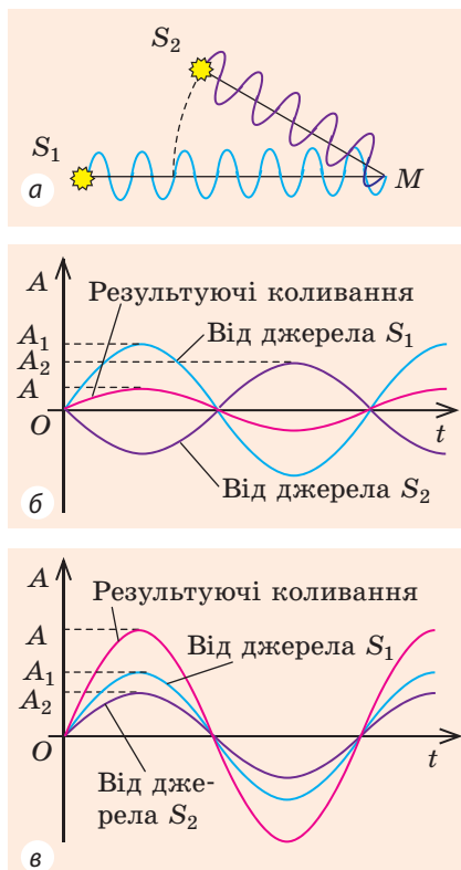
Рис. 22.6. Якщо хвилі надійшли в точку M у протилежних фазах, амплітуда результативних коливань зменшується: A = A_1 - A_2 (б), а якщо в однаковій фазі, амплітуда результативних коливань збільшується: A = A_1 + A_2 (в)
