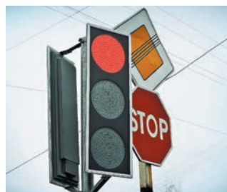
Рис. 9.3. Сигнали сучасних світлофорів добре помітні навіть тоді, коли яскраво світить сонце. У таких світлофорах лампи розжарення замінено на світлодіодні
