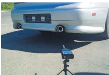
Рис. 5. Вимірювання рівня шуму від глушника автомобіля
