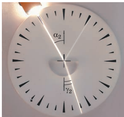
Рис. 12.3. Установлення законів заломлення світла: в разі зменшення кута падіння ( \alpha_2 < \alpha_1 ) кут заломлення теж зменшується ( \gamma_2 < \gamma_1 ), при цьому \frac{\sin \alpha_1}{\sin \gamma_1} = \frac{\sin \alpha_2}{\sin \gamma_2}
