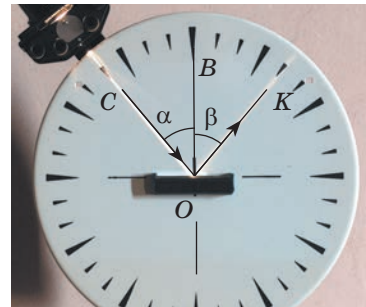
Рис. 11.2. Установлення законів відбивання світла за допомогою оптичної шайби: \alpha — кут падіння; \beta — кут відбивання
