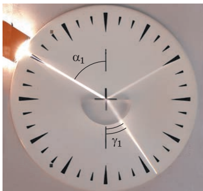
Рис. 12.3. Установлення законів заломлення світла: в разі зменшення кута падіння ( \alpha_2 < \alpha_1 ) кут заломлення теж зменшується ( \gamma_2 < \gamma_1 ), при цьому \frac{\sin \alpha_1}{\sin \gamma_1} = \frac{\sin \alpha_2}{\sin \gamma_2}
