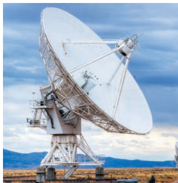
Рис. 21.3. Випромінювання вузького направленого пучка ультракоротких радіохвиль і приймання відбитого сигналу забезпечує параболічна антена радіолокатора
