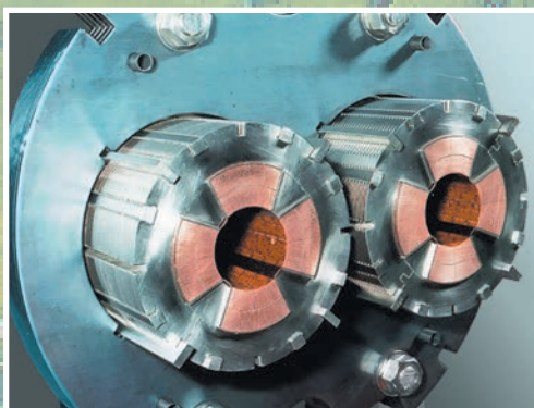
Рис. 2. Надпотужні магніти, які утримують заряджені частинки всередині прискорювача
