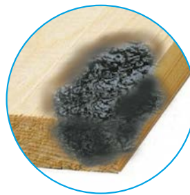
Мал. 22.2. Обвуглювання деревини концентрованою сульфатною кислотою
