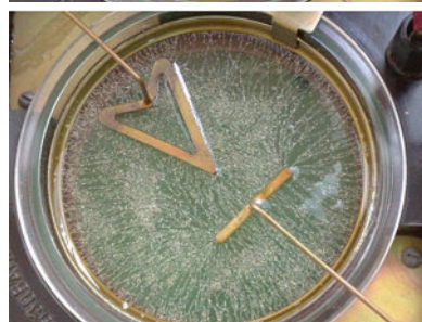
Рис. 31.5. Силові лінії електростатичного поля поблизу провідників
