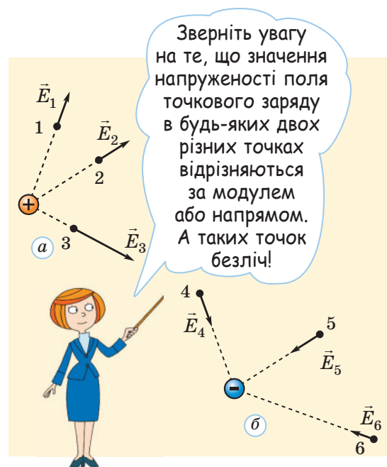
Рис. 30.2. Напруженість електричного поля позитивного точкового заряду в точках 1, 2, 3 напрямлена від цього заряду, а напруженість поля негативного точкового заряду в точках 4, 5, 6 напрямлена до цього заряду. В обох випадках модуль напруженості тим менший, чим далі точка від заряду
