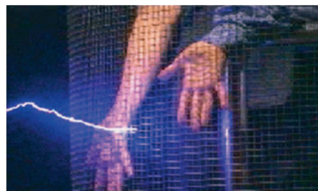
Рис. 31.4. Приклад електростатичного захисту
