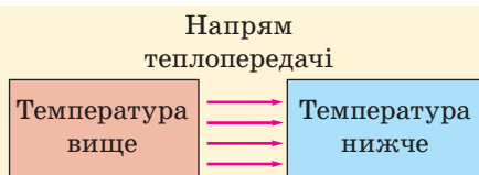
Рис. 22.1. Напрямок теплопередачі за відсутності теплової рівноваги між тілами
