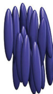
Рис. 25.3. Структура нематичного рідкого кристала
