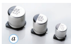
Рис. 33.3. Різні типи конденсаторів: а — полімерні; б — електролітичні; в — керамічні; г — паперовий
