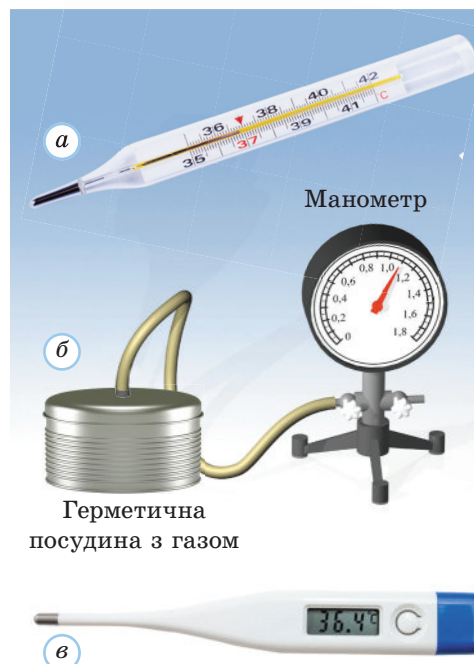
Рис. 22.2. Термометри: a — рідинний; б — газовий; в — електронний
