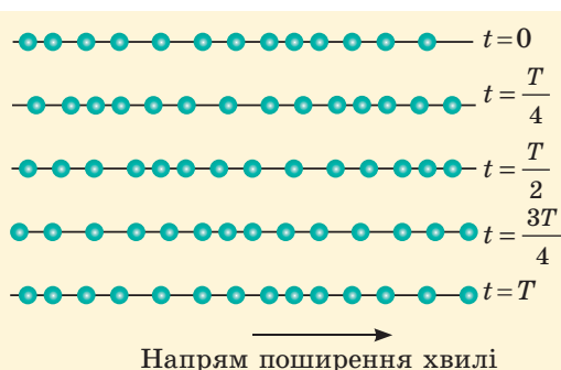
Рис. 17.2. Модель поздовжньої хвилі, що викликає стиснення та розтягнення середовища (пружні зв'язки між частинками не показано)
