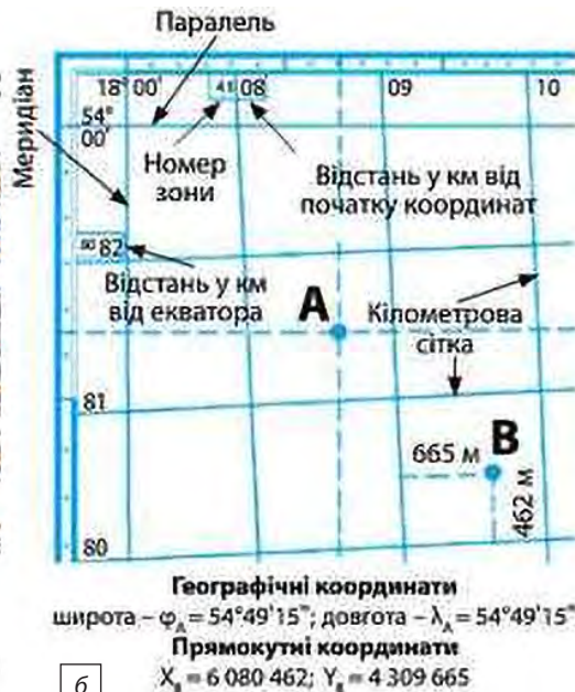
Мал. 3. а) Рамка і кілометрова сітка топографічної карти (1:100 000); б) зразок визначення географічних і прямокутних координат точок за картою.
