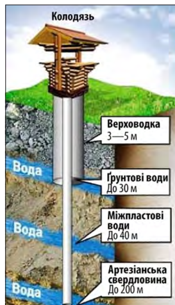
Мал. 2. Розташування підземних вод.
