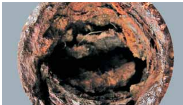
Мал. 48.2. Результати діяльності залізобактерій у водопровідних трубах
