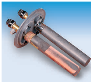
Рис. 37.5. Через кілька хвилин після початку пропускання струму через розчин хлориду міді поверхню катода вкриє тонкий шар міді
