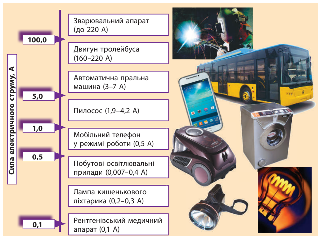
Рис. 27.4. Значення сили струму в деяких електротехнічних пристроях
