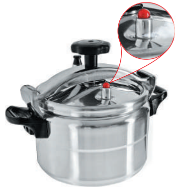
Рис. 14.5. Каструля-скороварка: завдяки клапанам і герметичній кришці підтримується високий тиск у просторі над рідиною, тому температура кипіння води в такій каструлі становить близько 120^{\circ}\text{C}
